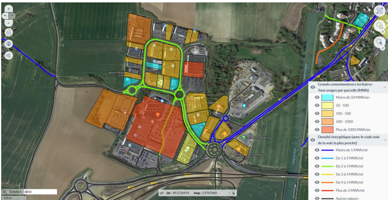
Figure 47 : Potentiel de développement réseaux de chaleur à Noyon ZAC du Mont Renaud avec croisement grands consommateurs – Source OPPORTUNITEE BURGEAP
